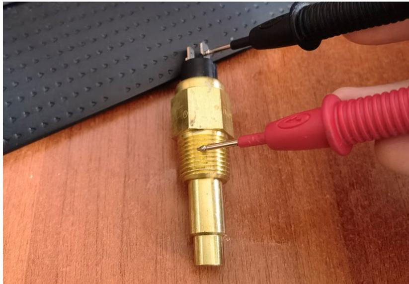
Método de medición: un cable del multímetro está conectado a la carcasa del sensor y el otro está conectado a la terminal G. Mida el valor de resistencia y luego busque la temperatura correspondiente al valor de resistencia de la tabla y compárela con la temperatura real del objeto detectado. Si es igual, significa que es normal. Si es diferente, significa que el sensor está defectuoso. Mira la tabla de abajo para más detalles:
